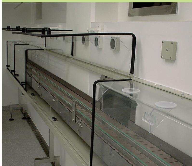
Cache de machine en PMMA
