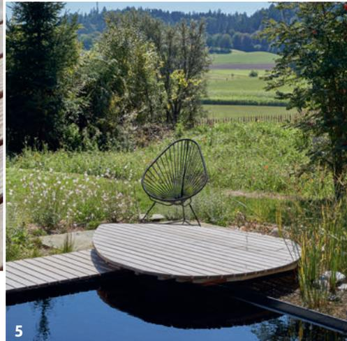
**1+2** Das schwarze Kunststoff-Becken des Naturpools wurde vom Spezialisten Semadeni AG nach Mass gefertigt. Die Overflow-Konstruktion unterstützt die Spiegelwirkung des Wassers. Der für die Reinigung zuständige Kieskörper mit Pflanzen und Mikroorganismen ist direkt mit dem Pool verbunden.
